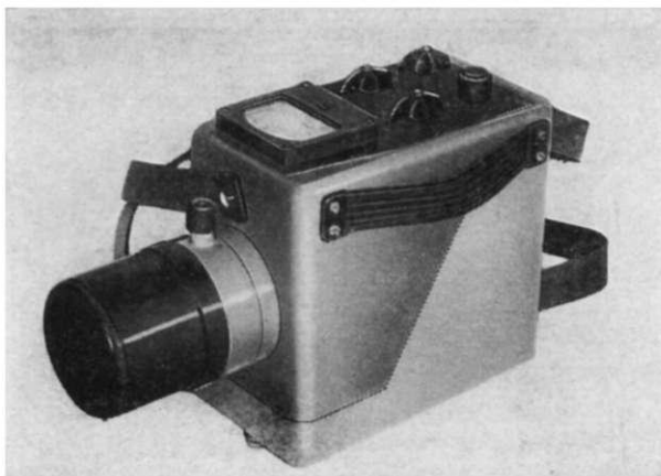
Рис. 5. Измеритель мощности дозы СГД-1.
