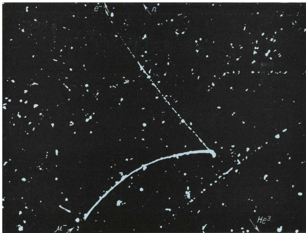
Рис. 5. Реакция синтеза двух ядер дейтерия, катализируемая отрицательным \mu -мезоном (ОИЯИ). После остановки \mu -мезона образовался мезоатом d\mu , в результате столкновения которого с дейтроном получилась мезомолекула dd\mu . В этой мезомолекуле произошла ядерная реакция синтеза
