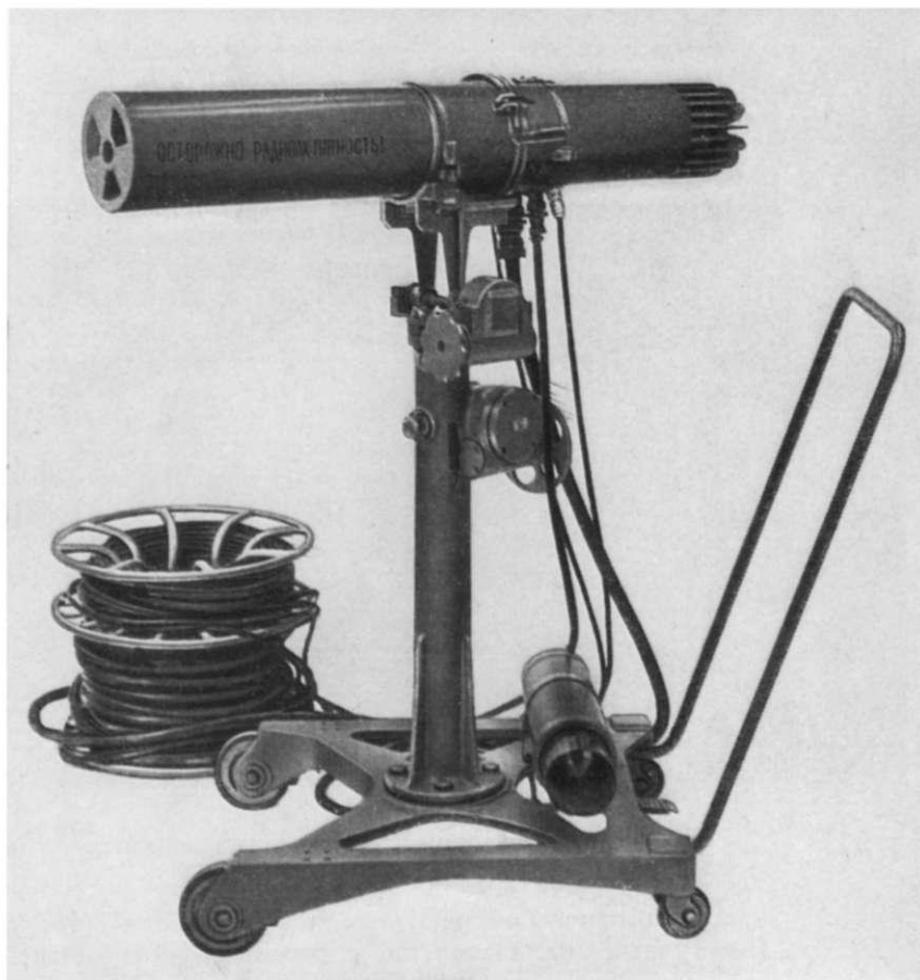
Рис. 12. Импульсный генератор нейтронов НГИ-1.
