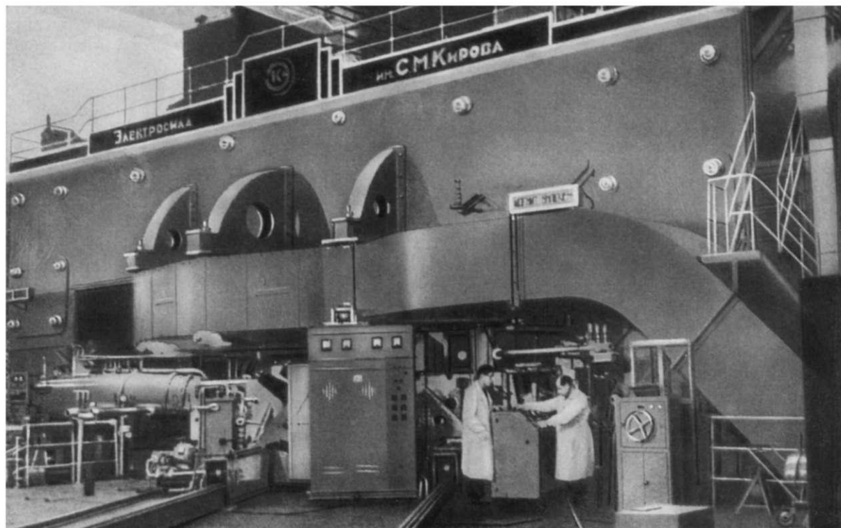
Рис. 3. Синхроциклотрон (фазотрон) на 680 Мэв.
