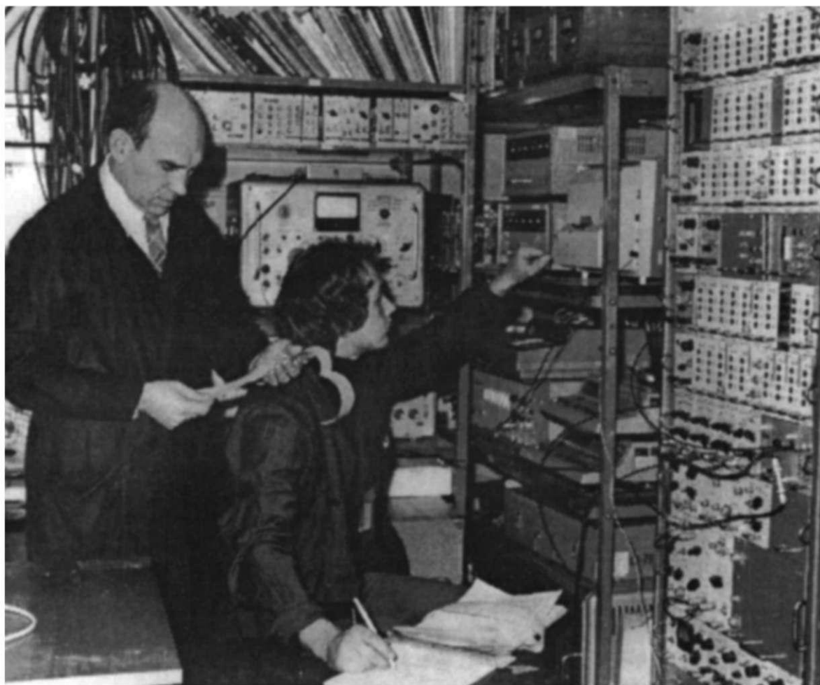
О. С. Цветков (стоит) и А. В. Мадлевский работают на установке нейтрон-нейтронных совпадений, входящих в состав отраслевого эталона единицы потока нейтронов
