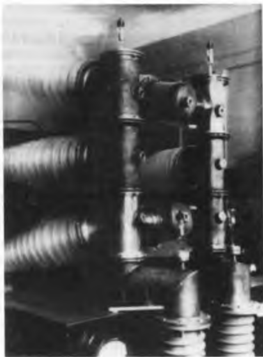
Рис. 5. Оптическая схема (а) и установка (б) для восьмикратного импульсного рентгенографирования
