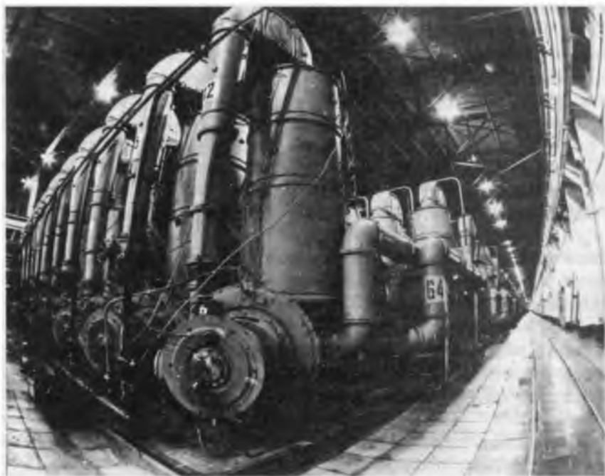
Рис. 1. Газодиффузионная ступень в каскаде
