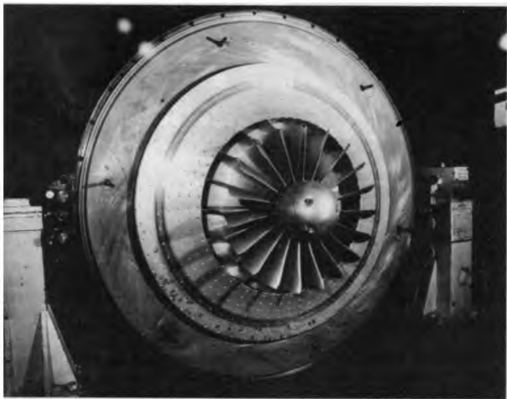
Рис. 3. Рабочее колесо центробежного сверхзвукового компрессора
