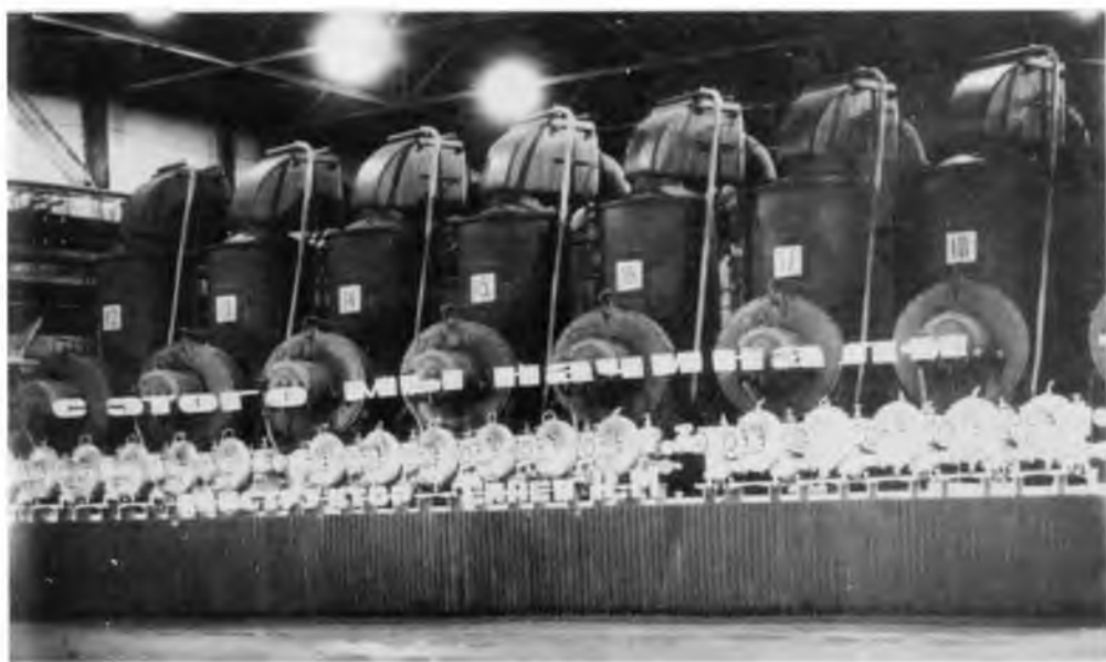
Рис. 4. Газодиффузионные ступени Т-56 (на заднем плане) и ОК-6 (на переднем плане)
