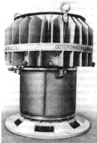
Рис. 9.7. Радионуклидная энергетическая установка второго поколения "Гонг" для питания навигационной аппаратуры (электрическая мощность 16 Вт, напряжение 14 В, КПД > 6%)
