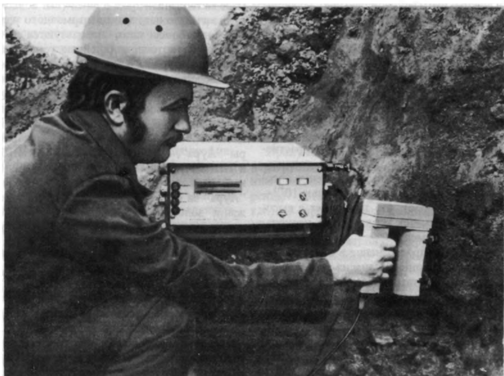
Рис. 9.2. Экспедиционный переносный рентгенорадиометрический анализатор ЭРА-1М, позволяющий проводить многоэлементный анализ образцов руд в полевых условиях
